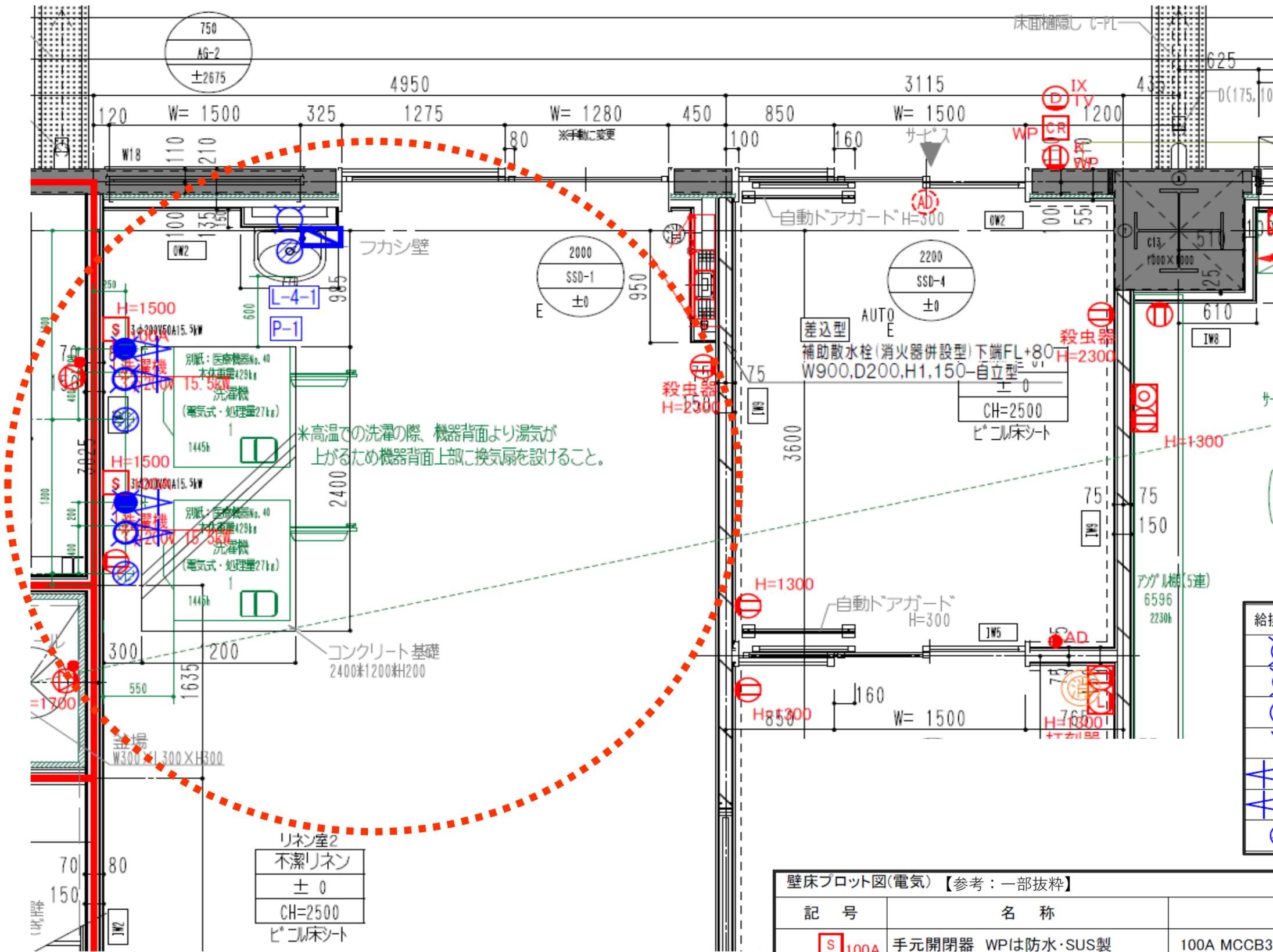
米高温での洗濯の際、機器背面より湯気が上がるため機器背面上部に換気扇を設けること。
