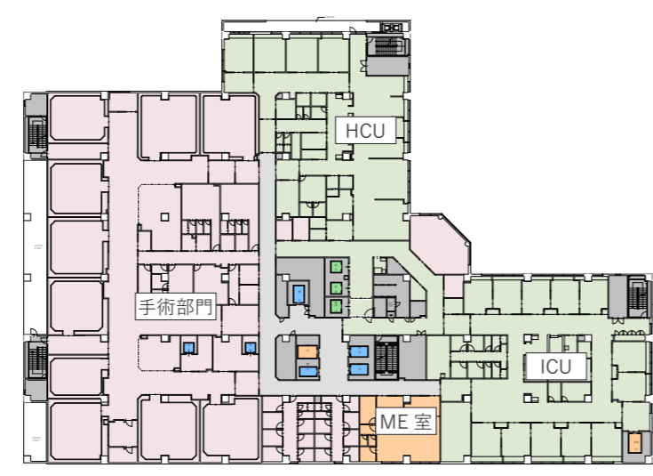
3F 手術室・高度医療フロア 下階の急病センターを含め手術部門と連携しやすい高度医療諸室を計画
